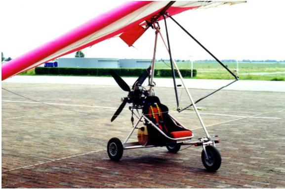
Dieses **Trike** besteht, wie bei unserem bewährten **Airpfeil - Trike**, aus wirbelstromgeprüften Luftfahrt – Aluminiumrohren mit Aluminium- und Edelstahlverbindungssteilen. **Neu** an diesem Gerät ist, dass alle Verbindungsstellen, die zum Auf- bzw. Abbau nötig sind, so einfach gehalten sind, dass sie jeder Pilot problemlos erkennt und eine Verwechslung unmöglich macht. Der drehbare Flügel für schmale Hangartore runden die Servicefreundlichkeit ab.
