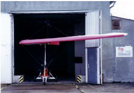
Das **Micropfeil – Trike** ist ein kleines klapp – und zerlegbares Gerät und für Piloten gedacht, die leicht und preiswert fliegen möchten, ohne auf Komfort und Stabilität zu verzichten. Zudem spart man noch die Kosten für einen Transportanhänger, da Trikerahmen und Flügel auf das Autodach und die übrigen Baugruppen in den Kofferraum passen. Dadurch wird das **Micropfeil – Trike** gleichzeitig urlaubsfreundlich, das heißt, man kann es in den Urlaub, z.B. nach Spanien, mitnehmen.
